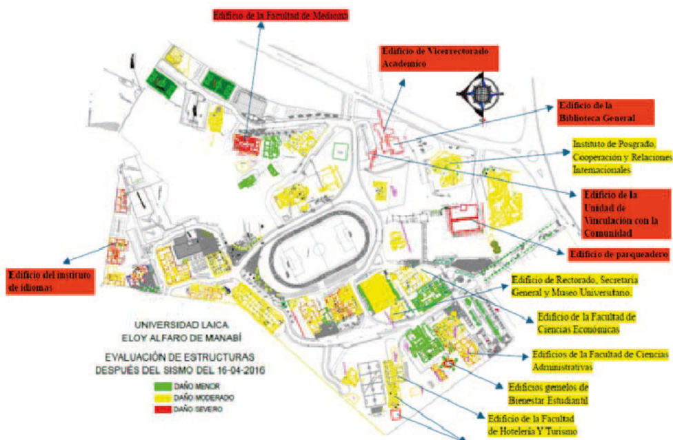
Figura 3.13. Estado de las edificaciones de la ULEAM después del sismo de 16 abril de 2016
